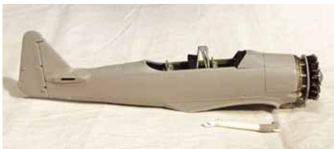
Ovan: Flygkroppen monterad. Notera det modifierade avgasröret. Foto: Peder Thorell.
